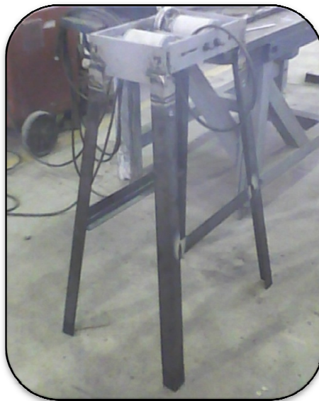
Figura 4.9 Estructura soldada con los ángulos de soporte
