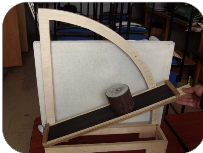
Figura 3.1 Plano Inclinado para determinar el coeficiente de rozamiento estático
