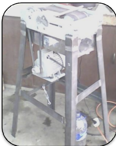
Figura 4.10 Sistema de transmisión de potencia montado
