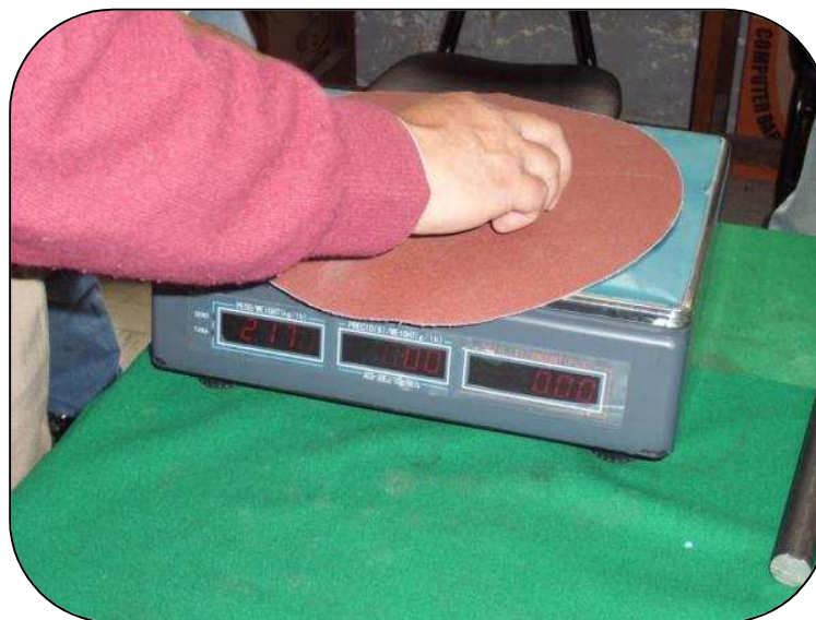
Figura 3.2 Simulación de la fuerza de pulido sobre balanza de precisión
