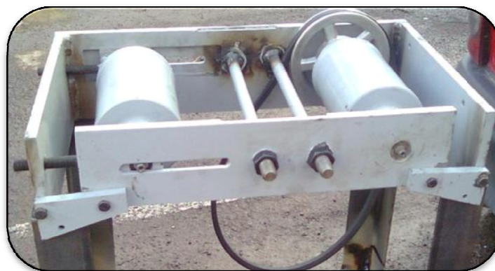
Figura 4.8 Barras tensoras de soporte soldadas
