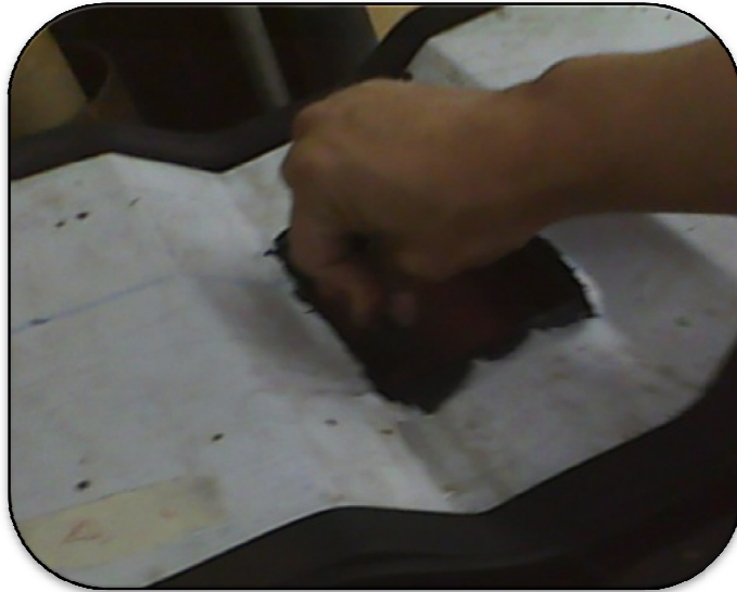
Figura 4.13 Pulido de probeta utilizando la tapa de protección de la desbastadora
