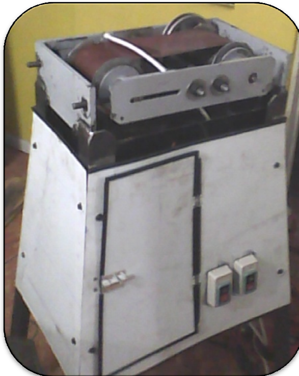
Figura 4.14 Desbastadora cubierta con la carcasa y con los controles de mando
