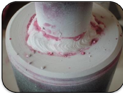
Figura 4.5 Ensayo de tintas penetrantes para verificar la calidad de soldadura
