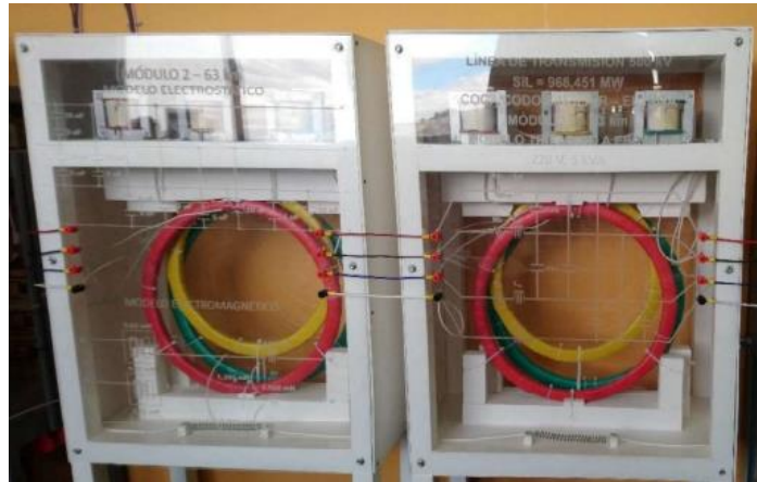
Figura 5. Modelo a escala de la línea de transmisión transpuesta de 500 kV
