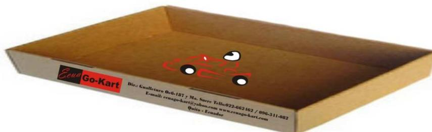
El vehículo terminado es envuelto en plástico adhesivo para protegerlo del polvo y la humedad, luego se coloca en cajas de cartón como muestra la figura para ser agarrado con correas plásticas para a continuación ser embodegado y listo para ser entregado.
