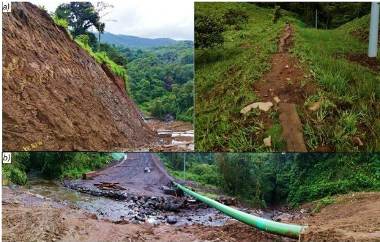
Figura 15. a) Suelo arenoso con mezcla de fragmentos de roca meteorizada b) depósitos coluviales con contacto a la avalancha de escombros del paleo Reventador (tonalidad gris) y el río Piedra Fina 2, presencia variante OCP (coordenadas 209077 E 995965 N)
