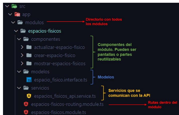
Figura 18. Organización usada para los módulos en frontend .
