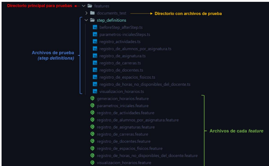
Figura 11. Estructura de la carpeta de pruebas ( features y step definitions ).
