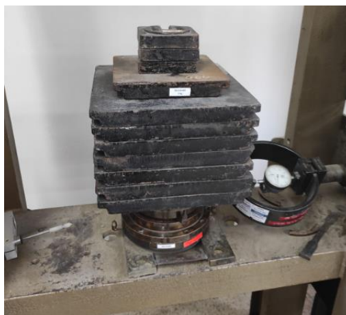
Figura 62. Ensayo de Corte Directo en suelo natural con esfuerzo normal de 2.0 kg/cm 2 .
