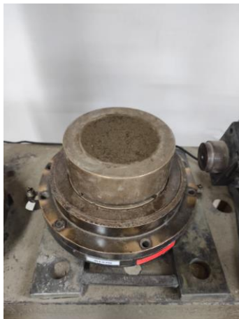
Figura 57. Colocación de muestra en máquina de corte directo Elaborado por: (Llumigusin & Pallango, 2022)
