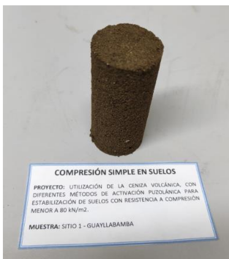
Figura 48. Muestra de suelo remoldeada para ensayo de compresión Simple Elaborado por: (Llumigusin & Pallango, 2022)
