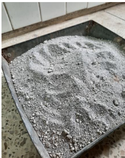
Figura 19. Muestra seca de ceniza del volcán Cotopaxi. Elaborado por: (Llumigusin & Pallango, 2022)
