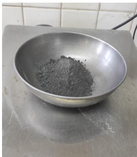
Figura 26. Material fino (ceniza) obtenido de la muestra del volcán Tungurahua Elaborado por: (Llumigusin & Pallango, 2022)
