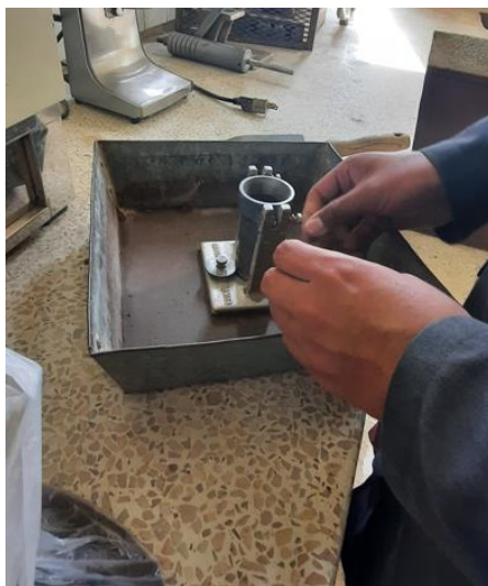
Figura 47. Remoldeo de muestra para ensayo de compresión Simple Elaborado por: (Llumigusin & Pallango, 2022)
