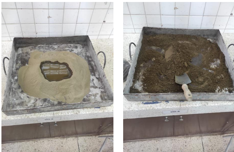
Figura 53. Suelo mezclado en humedad óptima para ensayo de corte directo Elaborado por: (Llumigusin & Pallango, 2022)
