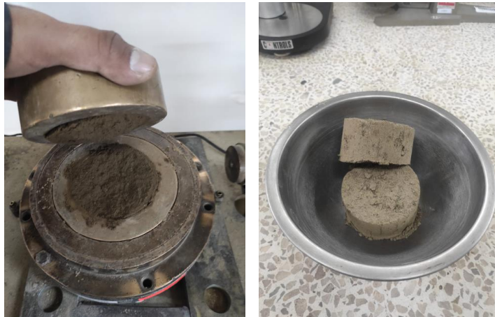
Figura 59. Falla en muestra por ensayo de corte directo Elaborado por: (Llumigusin & Pallango, 2022)
