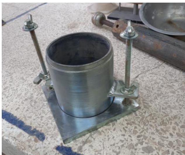
Figura 39. Molde para Proctor Estándar (método A) Elaborado por: (Llumigusin & Pallango, 2022)
