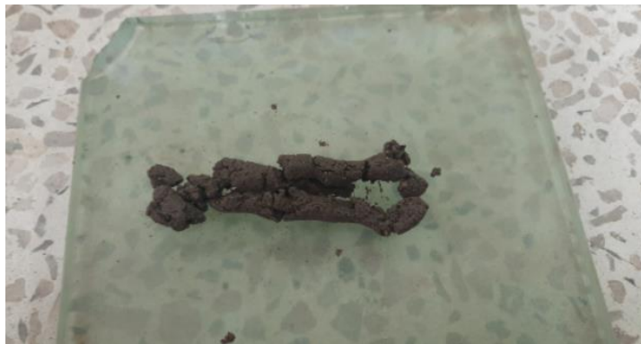
Figura 33. Cilindros de suelo natural para ensayo de límite plástico Elaborado por: (Llumigusin & Pallango, 2022)
