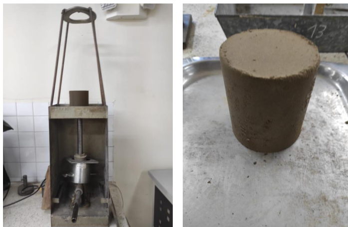
Figura 55. Muestra de suelo remoldeada para ensayo de corte directo Elaborado por: (Llumigusin & Pallango, 2022)
