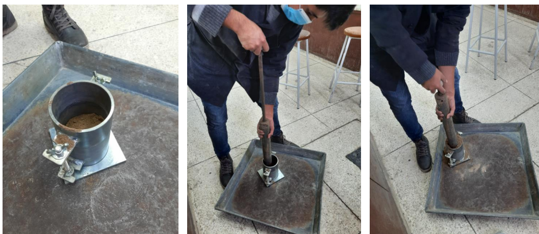
Figura 43. Ensayo de compactación Proctor Estándar (método A)
