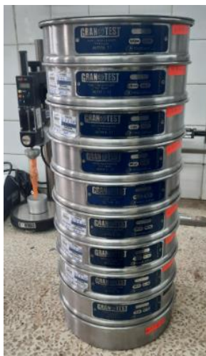
Figura 29. Tamices para granulometría Elaborado por: (Llumigusin & Pallango, 2022)
