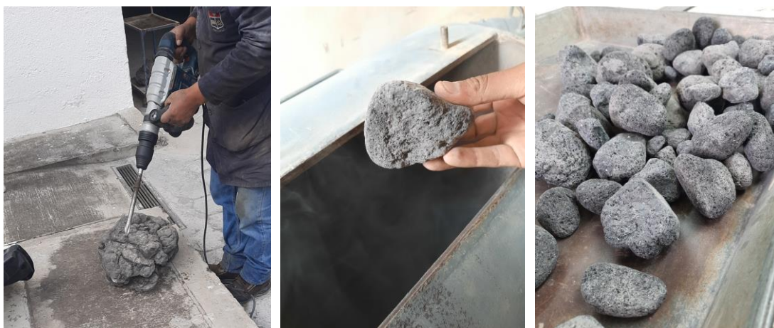
Figura 22. Proceso de molienda para las cenizas (volcán Tungurahua) Elaborado por: (Llumigusin & Pallango, 2022)
