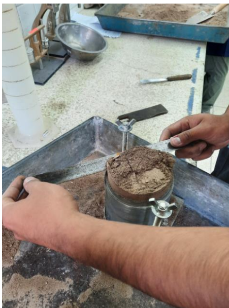
Figura 44. Enrazado de muestra natural para ensayo de Proctor Estándar (método A)
