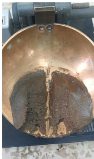
Figura 35. Suelo ranurado en copa de Casagrande Elaborado por: (Llumigusin & Pallango, 2022)
