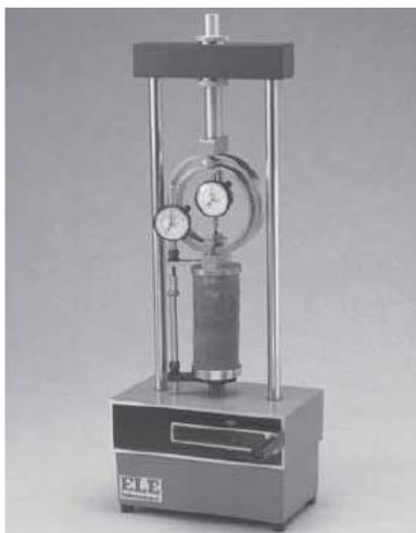
Figura 45. Equipo de prueba de Compresión no confinada (Resistencia a compresión simple) Fuente: (Das, 2013)
