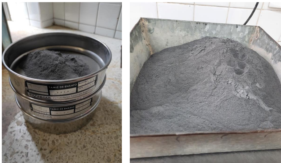
Figura 23. Proceso de tamizado para las cenizas (volcán Tungurahua) Elaborado por: (Llumigusin & Pallango, 2022)
