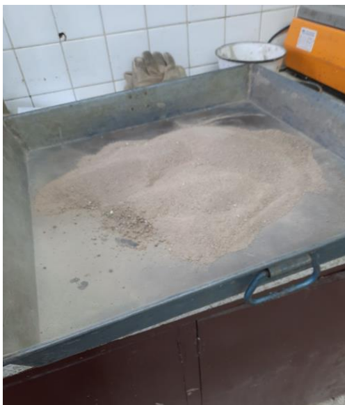
Figura 38. Suelo natural seco que pasa el tamiz #4 Elaborado por: (Llumigusin & Pallango, 2022)
