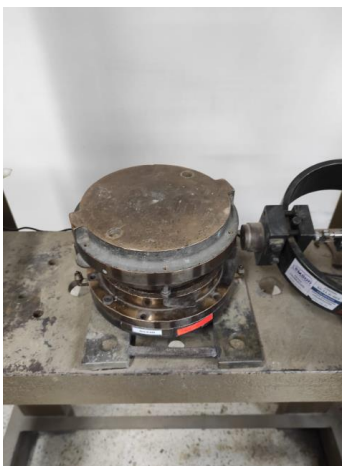
Figura 58. Máquina de corte directo ensamblada con muestra Elaborado por: (Llumigusin & Pallango, 2022)
