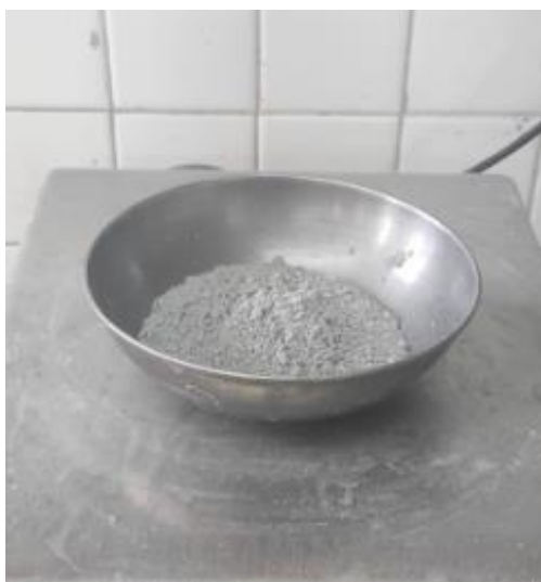
Figura 24. Material fino (ceniza) obtenido de la muestra del volcán Guagua Pichincha Elaborado por: (Llumigusin & Pallango, 2022)
