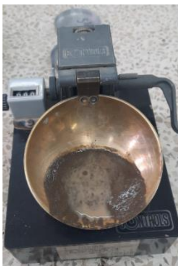
Figura 34. Suelo natural enraizado en copa de Casagrande Elaborado por: (Llumigusin & Pallango, 2022)
