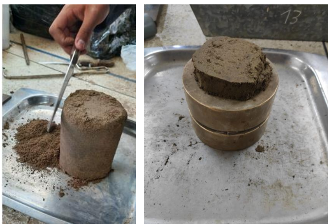
Figura 56. Tallado de muestra para ensayo de corte directo Elaborado por: (Llumigusin & Pallango, 2022)
