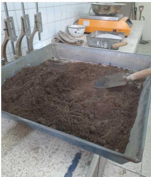
Figura 41. Suelo natural mezclado con agua para ensayo de Proctor Estándar (método A) Elaborado por: (Llumigusin & Pallango, 2022)
