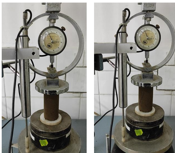
Figura 49. Ensayo de resistencia a la compresión simple Elaborado por: (Llumigusin & Pallango, 2022)
