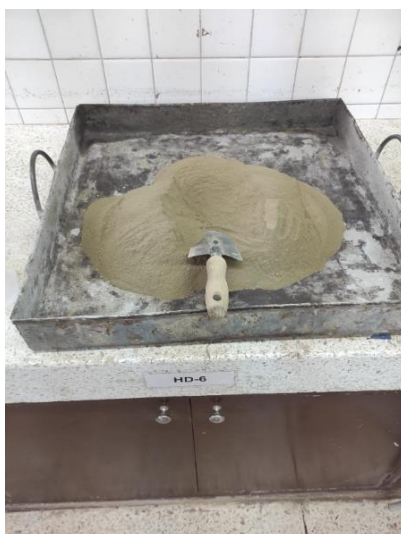
Figura 52. Suelo natural seco para ensayo de corte directo Elaborado por: (Llumigusin & Pallango, 2022)
