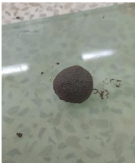
Figura 32. Esfera de suelo natural para ensayo de límite plástico Elaborado por: (Llumigusin & Pallango, 2022)
