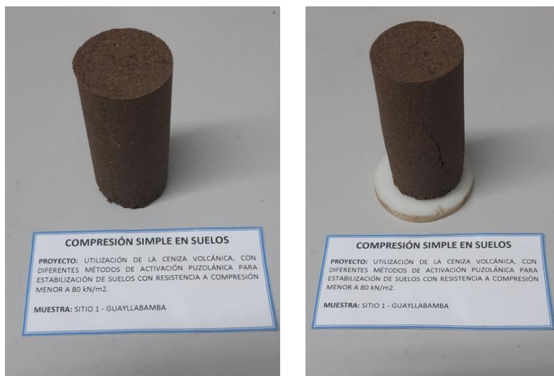
Figura 50. Evidencia fotográfica de la muestra antes y después de realizar el ensayo de compresión simple.
