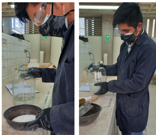
Figura 28. Preparación de solución de Hidróxido de Sodio con concentración de 10 M
