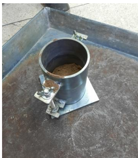
Figura 54. Remoldeo de muestra para ensayo de corte directo Elaborado por: (Llumigusin & Pallango, 2022)
