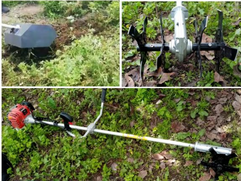
Figura 2.26. Montaje de elementos que constituyen la deshierbadora mecánica. (Fuente: Propia)
