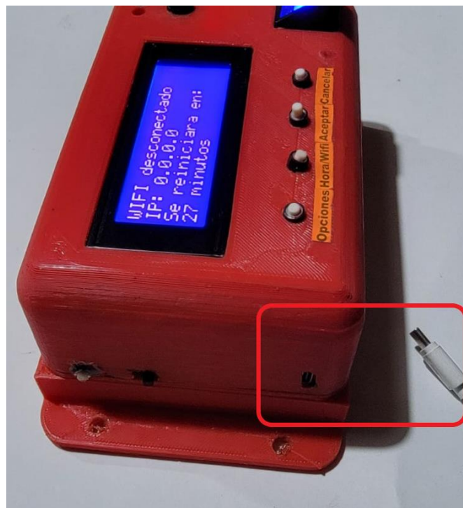
Figura 3.17. Verificación de funcionamiento sin alimentación.
