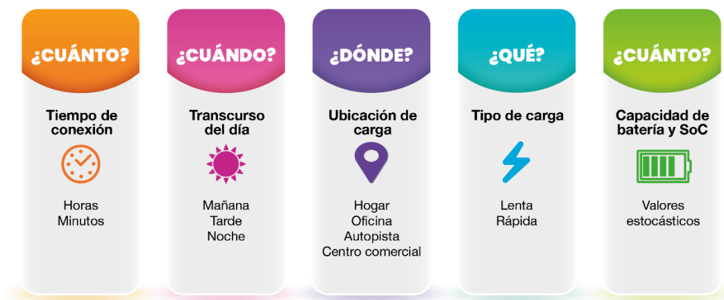
Figura 2. 6. Factores considerados para la previsión de carga de un VE.
