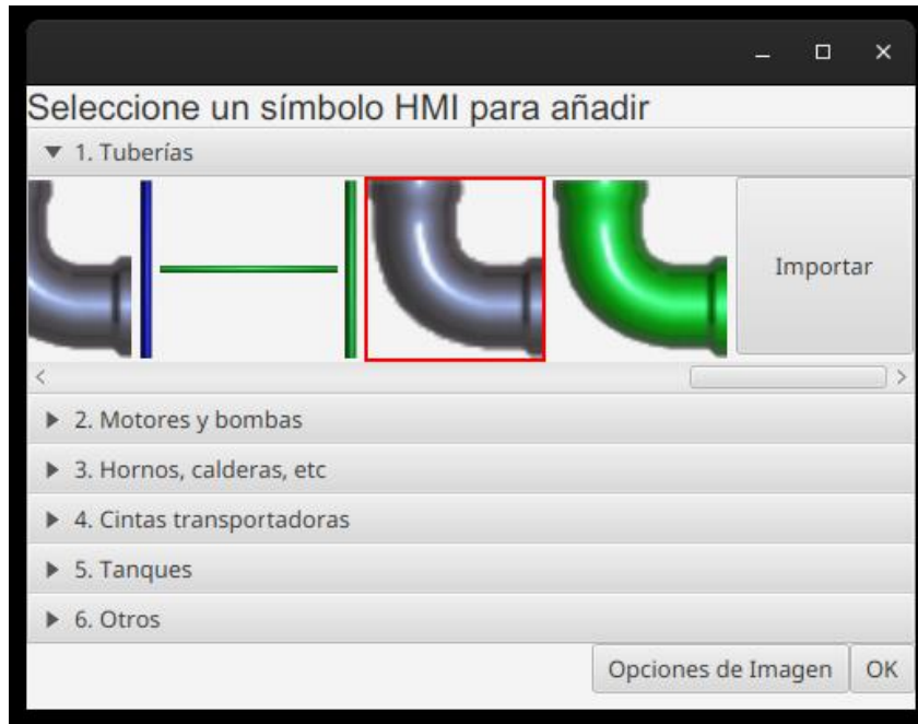
Figura 2.31 Seleccionador de imágenes predeterminadas con una nueva imagen añadida Implementación de ventana para definir alarmas
