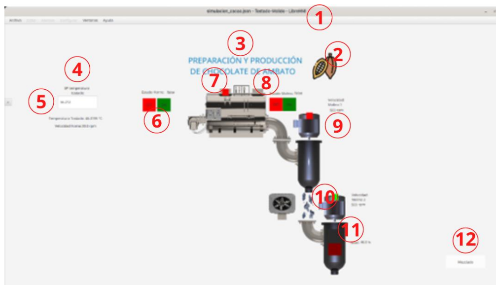
Figura 3.4 Pantalla de proceso de tostado y molido en LibreHMI, con elementos numerados para su posterior comparación
