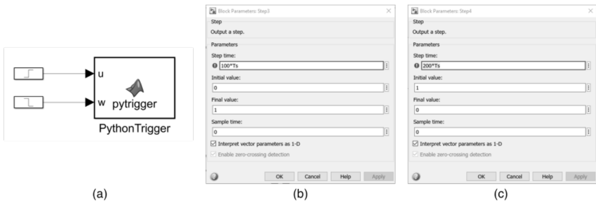
Figura 2.33: Esquema de la generación de la señal de disparo de co-simulación en Simulink. (a) Vista general. (b) Configuración de la señal u . (c) Configuración de la señal w .
