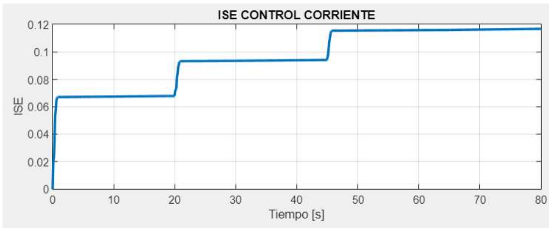
Figura 3.6 Simulación ISE control de corriente topología DC/DC.
