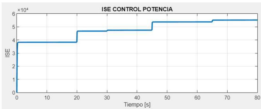
Figura 3.1 Simulación ISE control de potencia topología DC/AC.
