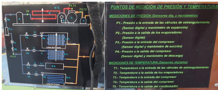
Figura X. II Esquema de ubicación de instrumentos en el equipo de refrigeración (Fuente: Propia)
