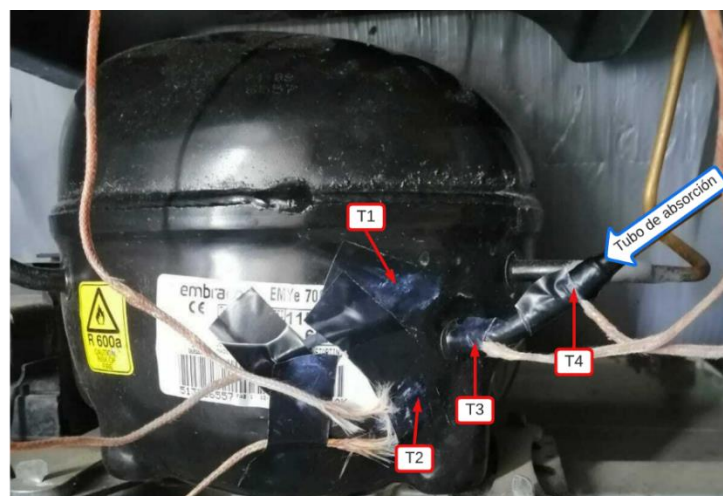
Figura I. V Ubicación de termocuplas de manera física en el compresor y el tubo de absorción (Fuente: Propia)
