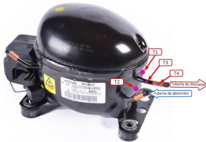
Figura I. VI Esquema de ubicación de termopares en el compresor y tubo de descarga (Fuente: Propia)
