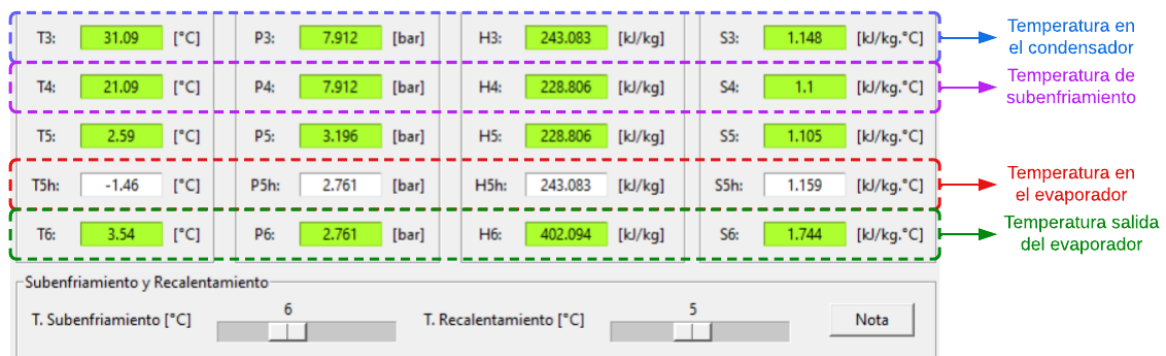
Figura 3. 9 Configuración de subenfriamiento y recalentamiento para evaluar el sistema con CCT. (Fuente: Propia)
