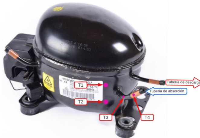
Figura I. IV Esquema de ubicación de termocuplas en el compresor y tubo de absorción (Fuente: Propia)
