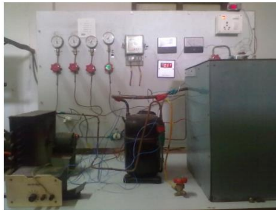
Figura 1. 3 Banco de refrigeración creado por Subramani N. (Fuente: [15])
