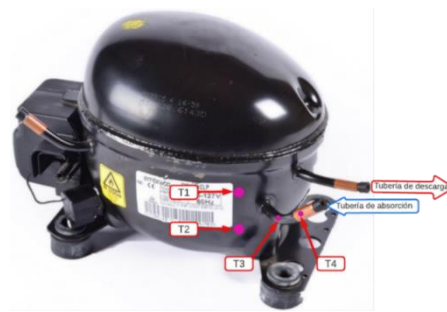
Figura 2. 9 Esquema de ubicación de termopares en compresor y la tubería de absorción. (Fuente: Propia)
