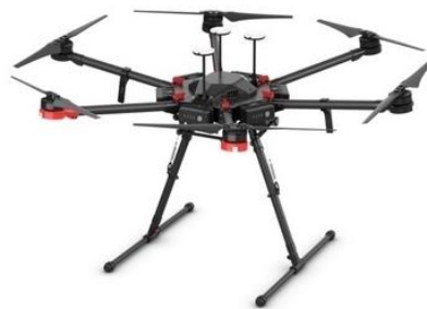
Figura 1.7. Hexacóptero DJI Matrice 600 Pro [22].
