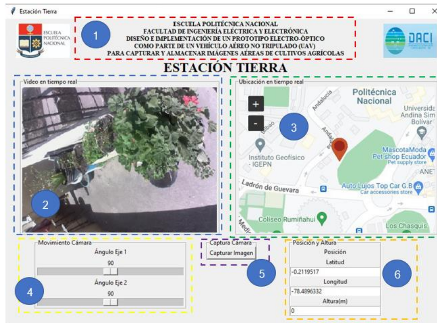
Figura 2.53. Interfaz Hombre Maquina (HMI) para la captura de imágenes.
