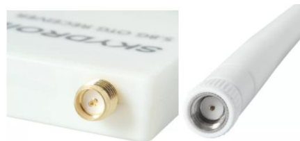
Figura 2.33. Conexión de la antena RP-SMA con el receptor (VRX) [72].
