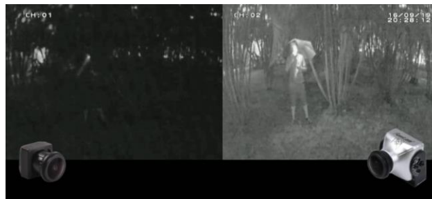
Figura 1.17. Cámara FPV IR Block vs. Cámara FPV IR Sensitive [47].
