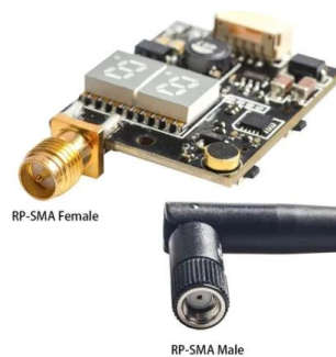
Figura 2.30. Conexión de la antena RP-SMA con el transmisor (TVX) [72].
