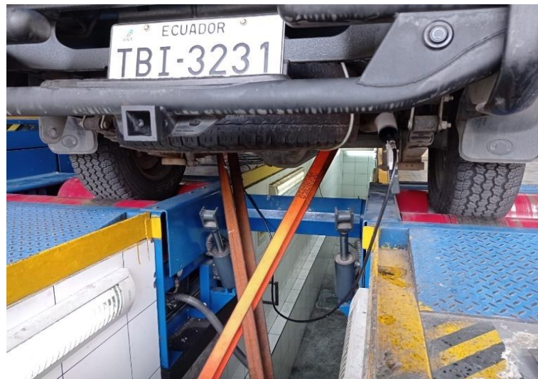
Figura 2. 13. Instalación de sonda del analizador de gases del MET 6.3. (Fuente: Autores,2022)
