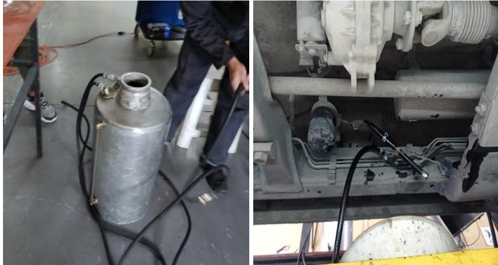
Figura 2. 12. Conexión del tanque de combustible externo al vehículo de prueba. (Fuente: Autores,2022)
