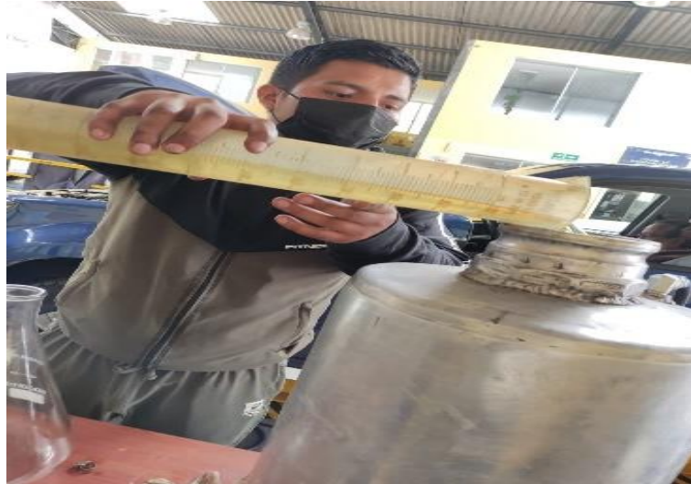
Figura 2. 20. Cambio de combustible en el tanque externo. (Fuente: Autores,2022)
