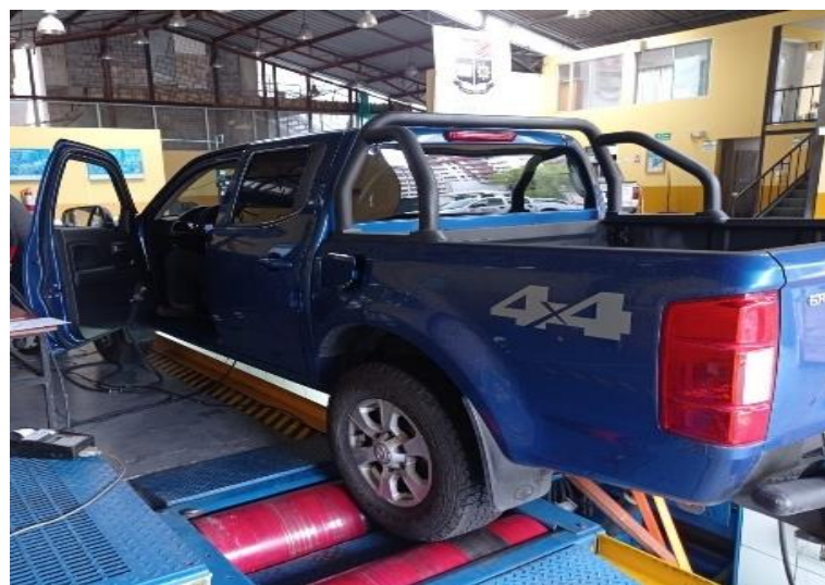
Figura 2. 9. Centrado de las ruedas del vehículo con los rodillos LPS 3000. (Fuente: Autores,2022)
