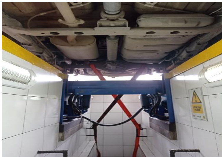
Figura 2. 10. Anclaje del vehículo de pruebas al dinamómetro LPS 3000. (Fuente: Autores,2022)
