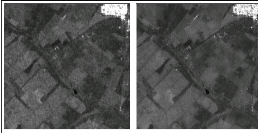
Figura 21. La imagen izquierda se encuentra sin filtro, en la derecha imagen con filtro de moteado. Fuente: SARMAP (2009)
