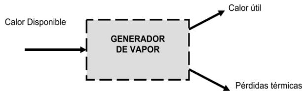
Figura 2.37 Diagrama de energías para la generación de vapor.
