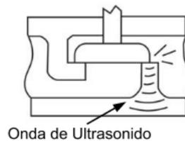
Figura 2.46 Generación de ondas de ultrasonido en asiento de una trampa de vapor.
