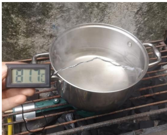
Figura 2.21 Verificación de temperaturas con agua caliente. Fuente: Propia.
