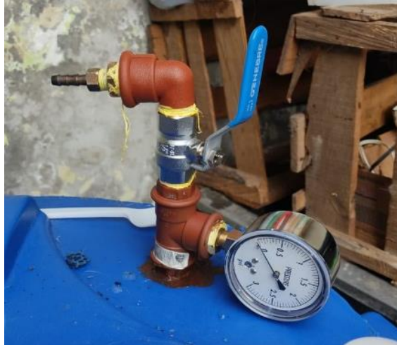
Figura 2.12 Conexión de la salida de biogás. Fuente: Propia.
