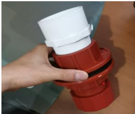
Figura 2.10 Unión de tanque y adaptador PVC. Fuente: Propia.
