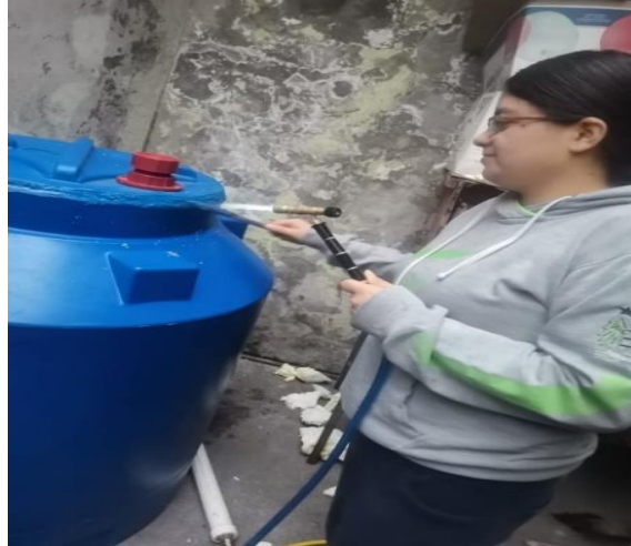
Figura 2.14 Soldadura del tanque. Fuente: Propia.
