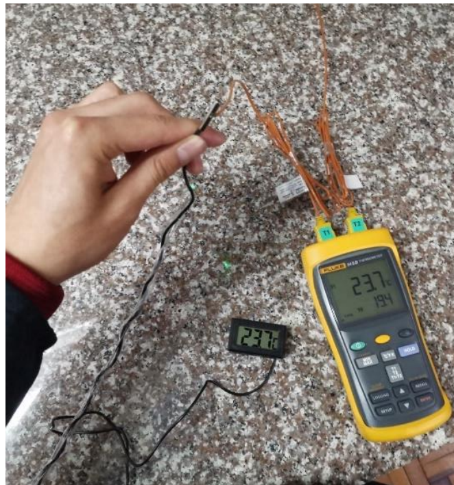
Anexo 7. Verificación de la sonda en agua a temperatura ambiente
