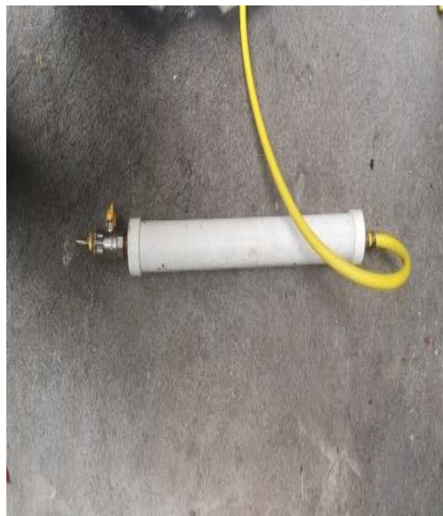
Figura 2.13 Conexión Filtro de Sulfuro de Hidrógeno. Fuente: Propia.
