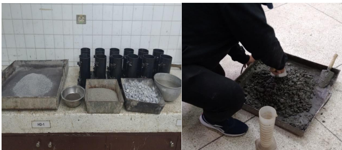
Figura 25. Mezcla de hormigón
