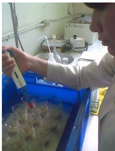
Figura A.4.15. Determinación de la tasa de digestión del almidón
