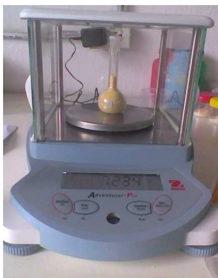
Figura A.4.13. Determinación de densidad aparente
