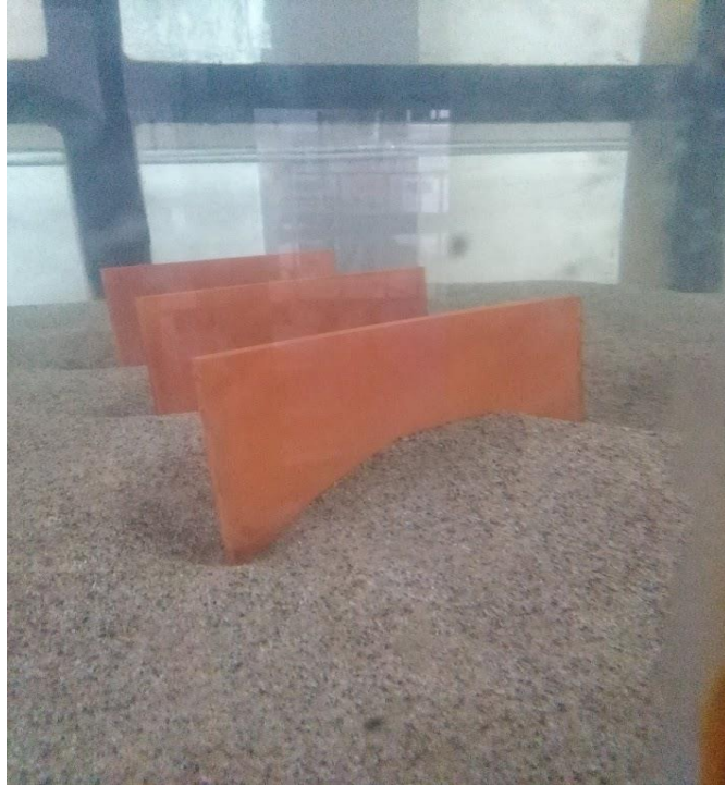
Figura 4.93 Perfil Lecho (Sedimentación y socavación)
