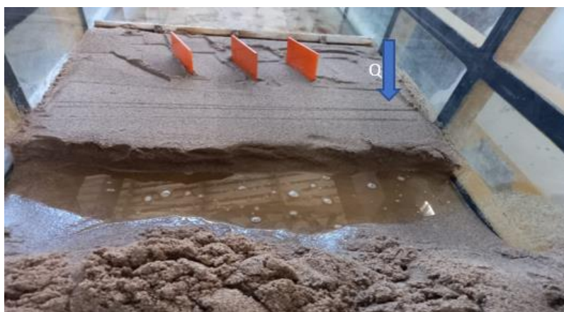
Figura 3.10. Colocación de los paneles en el Canal Hidrodinámico
