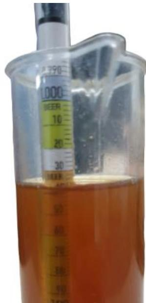
**Figura 3.25** Medida de densidad después de cocción
