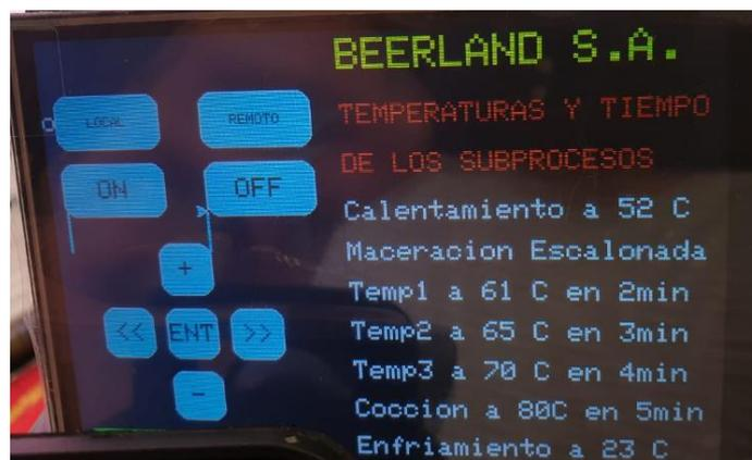
Figura 2. Pantalla de cambio de variables del proceso
