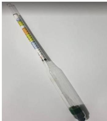
**Figura 1.14.** Hidrómetro
