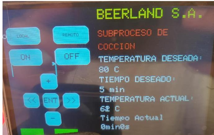
Figura 3. Visualización de las variables del proceso a tiempo real
