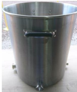
**Figura 2.3.** Tanque para el calentamiento de agua
