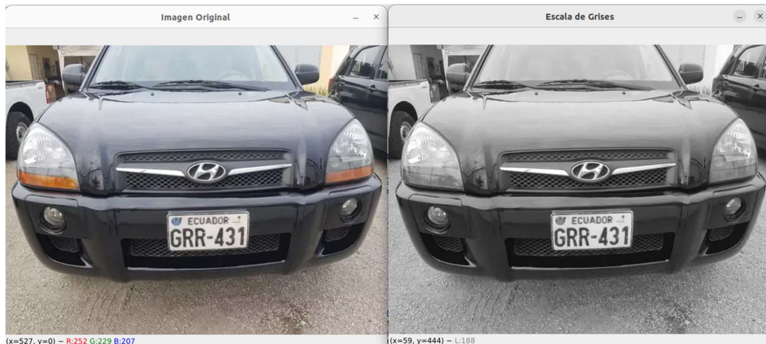
Figura 9. Izquierda: imagen original, en la parte inferior se puede visualizar los valores del píxel seleccionado. Derecha: imagen en escala de grises, en la parte inferior se puede visualizar el valor del píxel seleccionado
