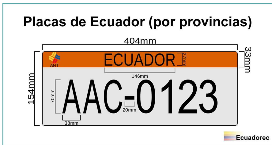
Figura 8. Dimensiones y estructura de la placa vehicular ecuatoriana
