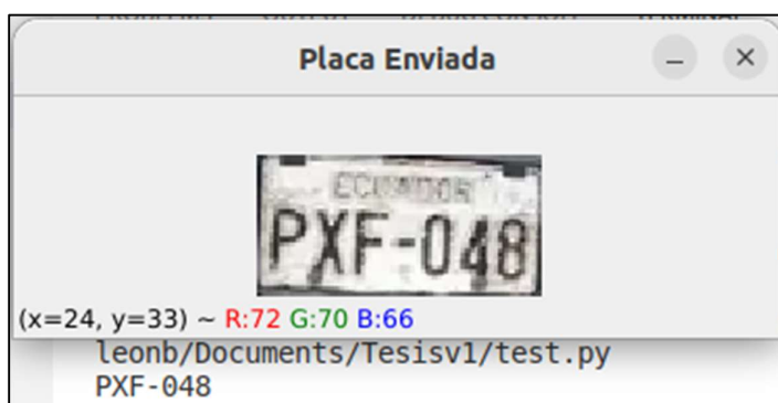
Figura 14. Imagen enviada con extracción exclusiva de la placa
