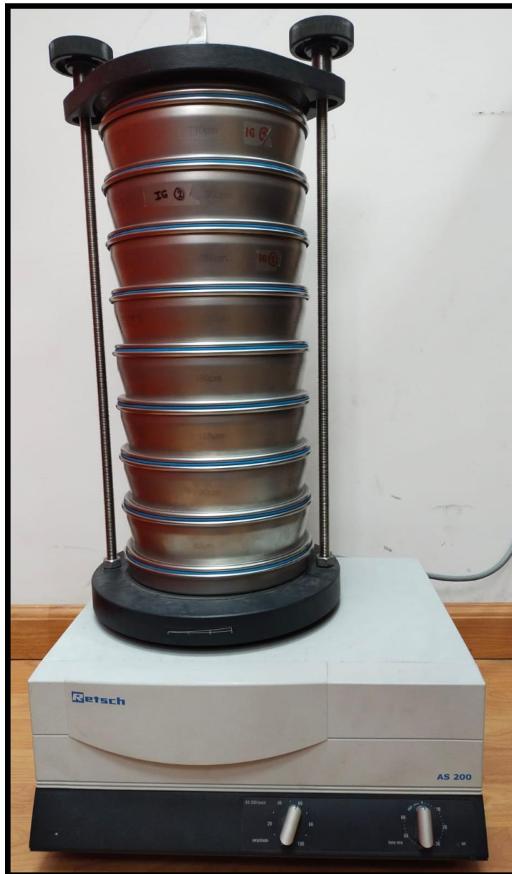
Figura 3.2. Tamices con la fracción más fina de cenizas (710 \mu\text{m} hasta < 63 \mu\text{m} ) sobre el vibrador marca Retsch propiedad del IG-EPN.
