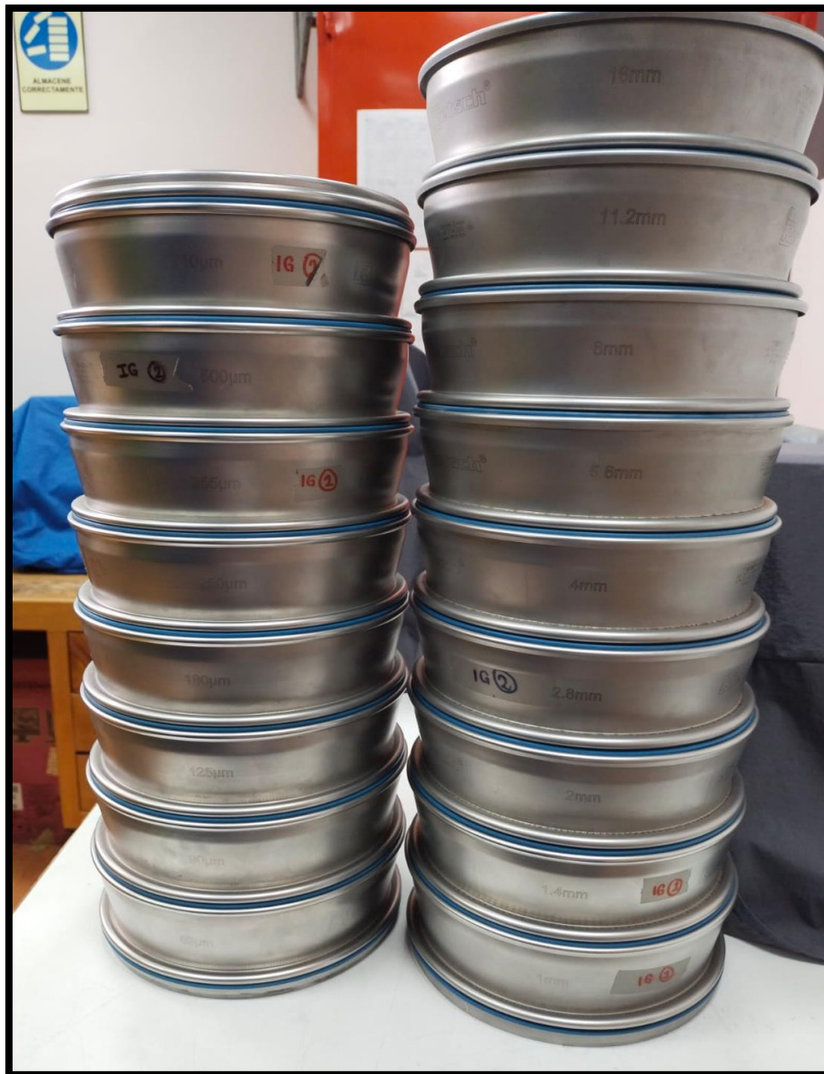
Figura 3.1. Tamices con aberturas desde los 16 mm hasta 63 \mu\text{m} utilizados para este trabajo.
