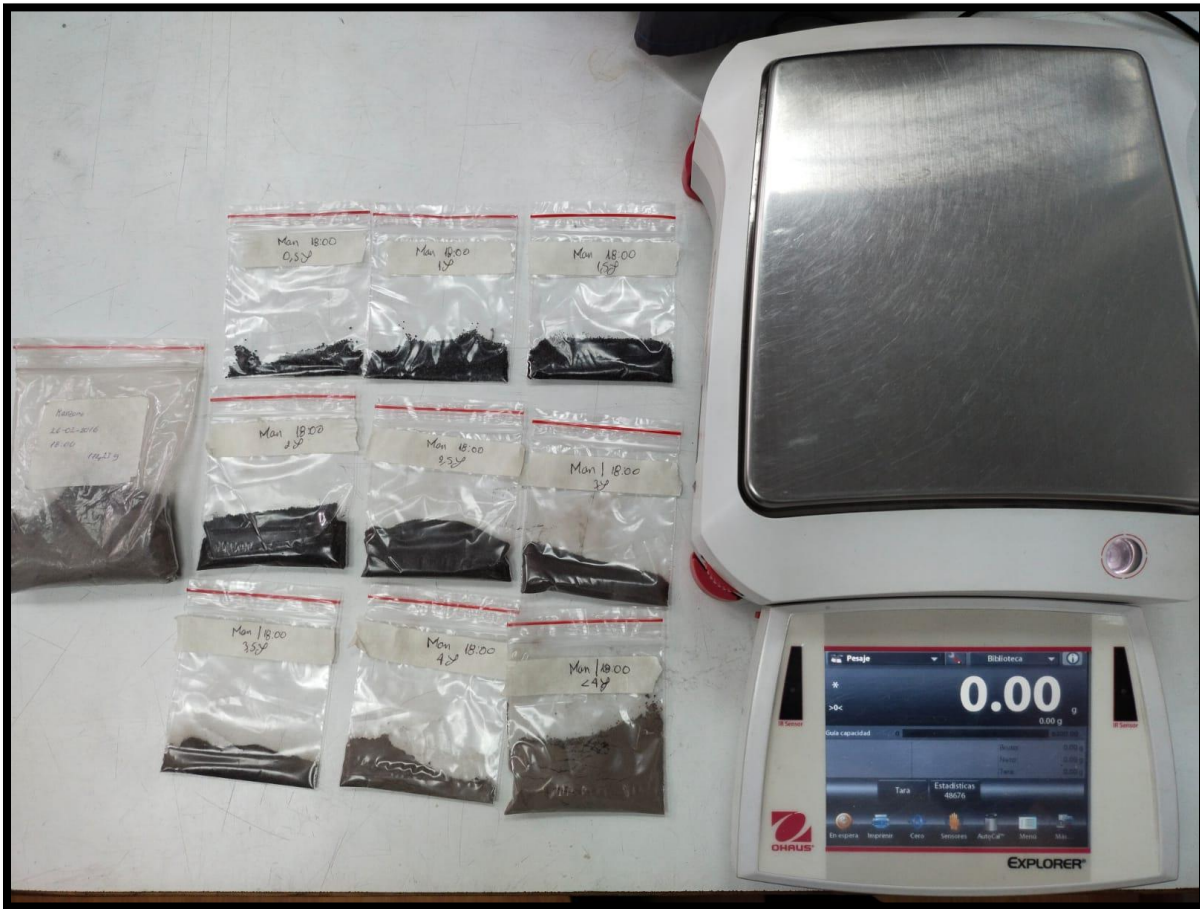
Figura 3.3. Balanza de precisión y cenizas separadas según su distribución granulométrica en fundas individuales para la muestra TUN-16-02.
