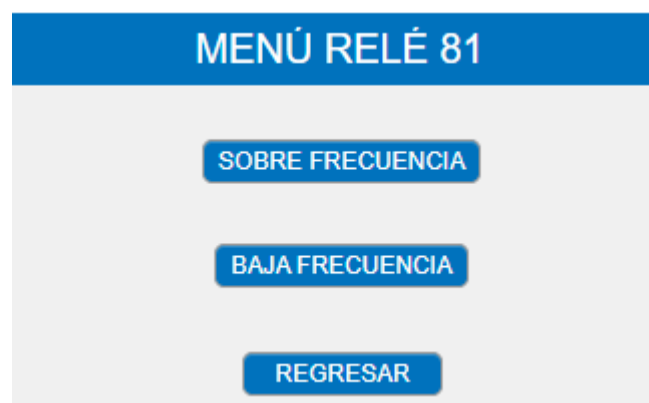
Figura 2.30 Submenú de la protección de sobre y baja frecuencia.
