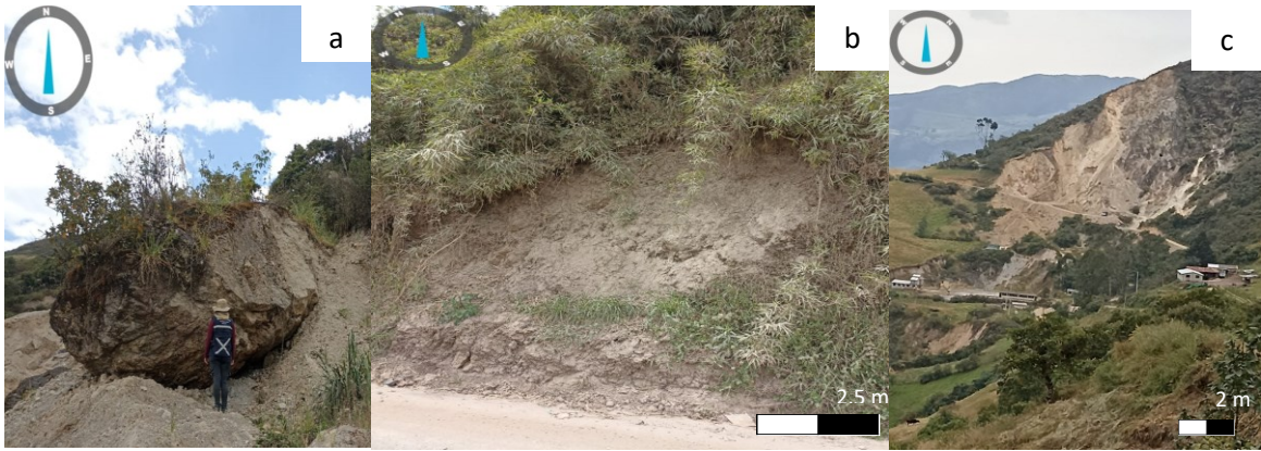
Fotografía 4.4 a) Bloques métricos al largo de los caminos b) deslizamientos pequeños en los bordes de los caminos c) mineras artesanales de áridos UTM (731490 / 9747321)
