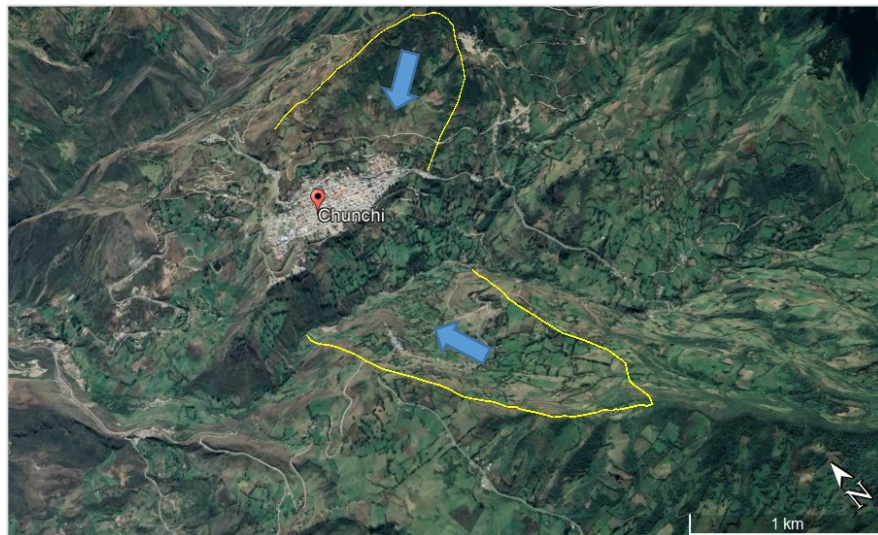
Figura 3.14 Características movimientos inactivos. Se observar deslizamientos con escarpes suavizados (amarillos). Zonas que indican superficies con cobertura vegetal las cuales se encuentran en el deslizamiento (flecha azul). No se observa grietas en las zonas de los deslizamientos. (Google Earth Pro, 2022)
