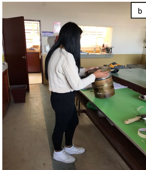
b) Tamizado por 6 tamices de diferente tamaño #: 4, 10, 20, 40, 140, 200
