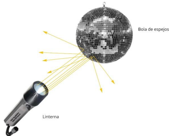
Figura 1.3 Dispersión de una señal en una superficie irregular [5].
