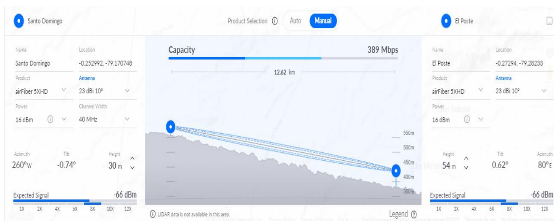
Figura 3.9 Resultados del radioenlace entre Santo Domingo de los Colorados y El Poste.
