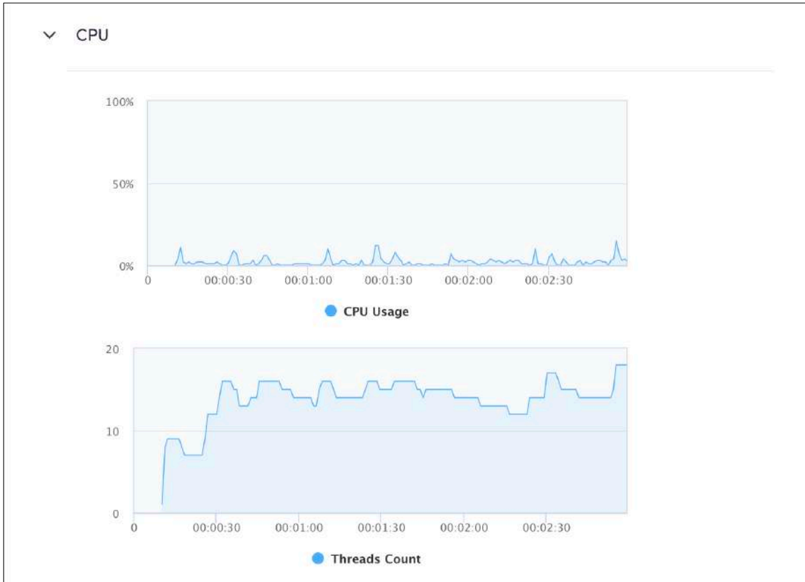
Figura 163– Gráfico del uso de la CPU y el recuento de hilos de la segunda prueba
