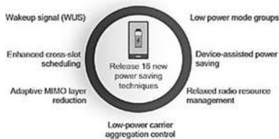
Figura 1.16: Esquema Ahorro de Energía en 5G NR [9]
