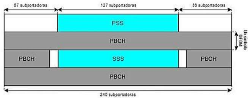
Figura 1.11: Estructura del SS block [8]
