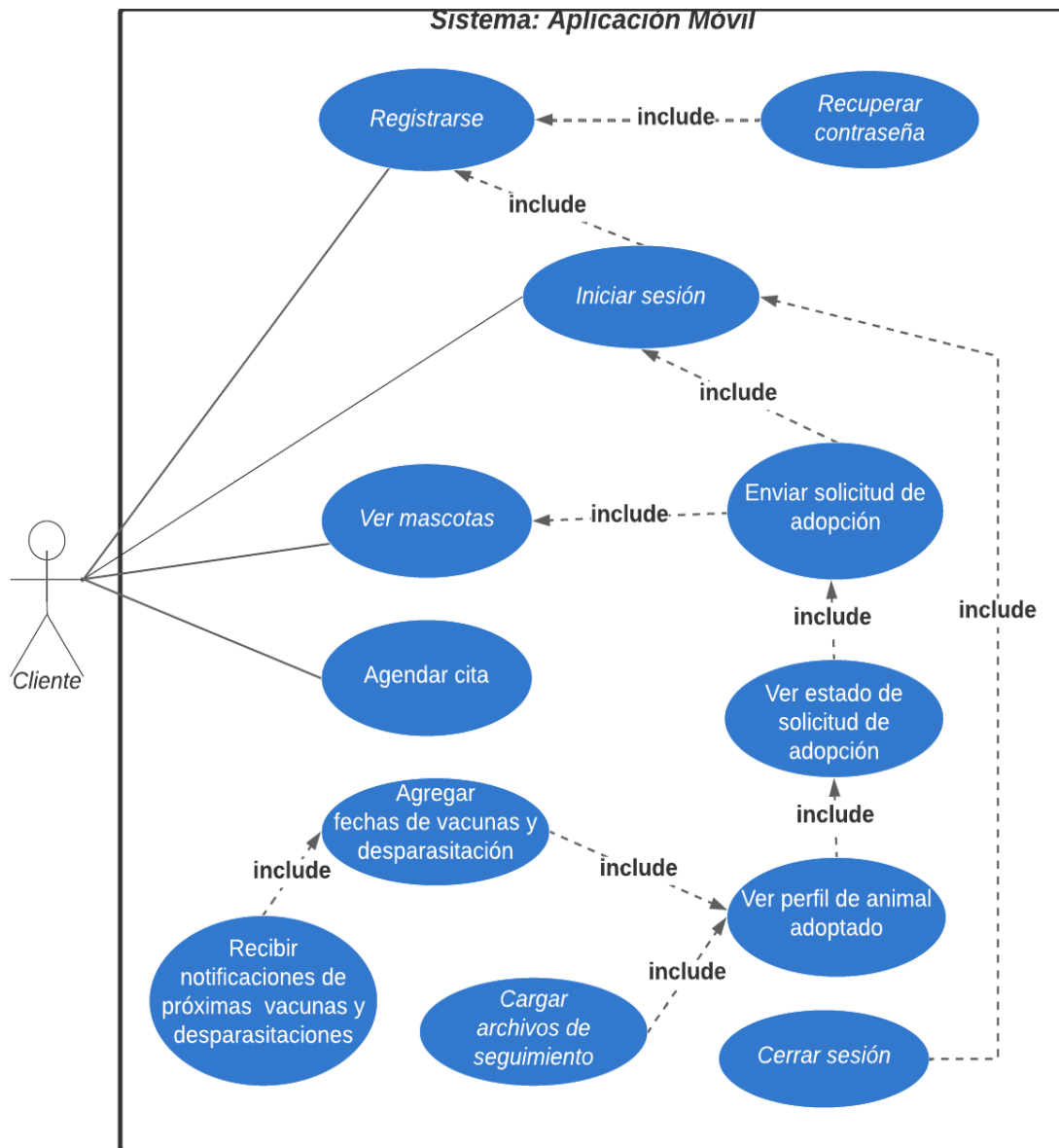
Figura 2.2. Diagrama de Casos de uso de la aplicación móvil para el usuario Cliente
