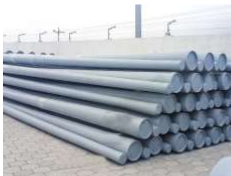
Figura 3.5. Postes de fibra de vidrio embodegado
