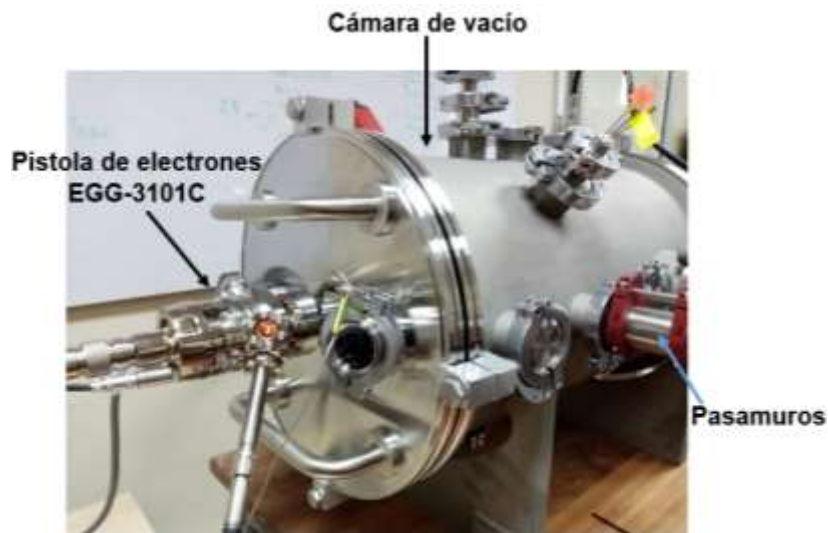
Figura 1.10. Pistola de electrones EGG-3101C acoplada a una cámara de vacío
