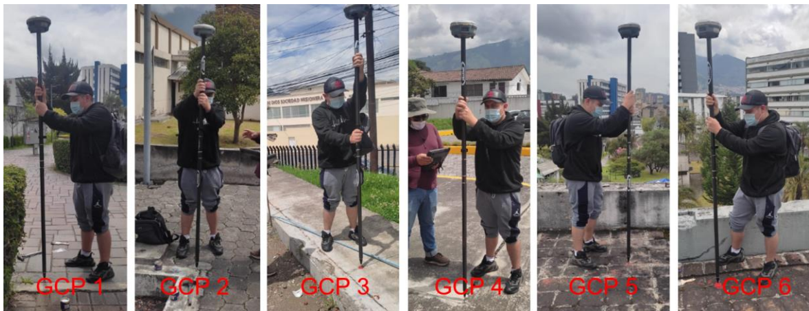
Figura 32. Colocación en campo de los GCP
