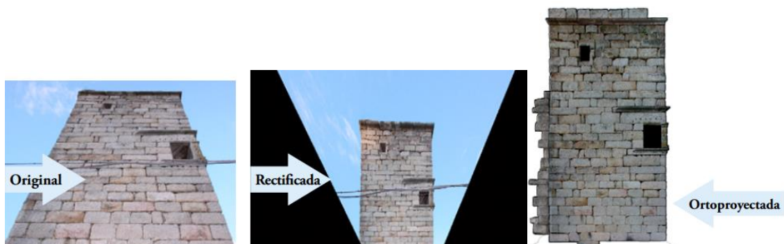
Figura 13. Utilización de la diferencia de paralaje en restitución fotogramétrica.
