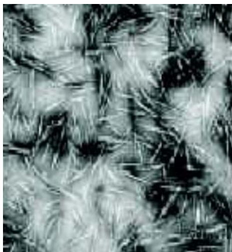
Figura 1.4 Cristales de Nanocelulosa en imagen TEM (Habibi, Lucia, & Rojas, 2010).
