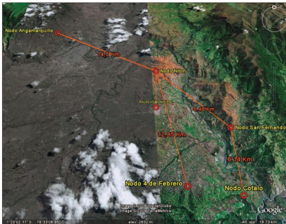
Figura 2.15 Topología Física de la Red de Backbone.
