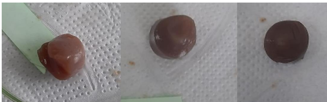
Figura 3.2. Hidrogeles a 100°C con una concentración de 4, 5 y 6% (De izquierda a derecha).
