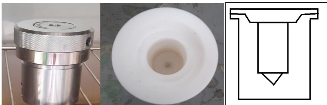
Figura 2.1. Reactor de síntesis hidrotermal, recipiente de teflón de 11 mL y diagrama de la forma del recipiente de teflón.
