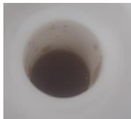
Figura 3.1. Recipiente de teflón con el hidrogel después del proceso de síntesis hidrotermal
