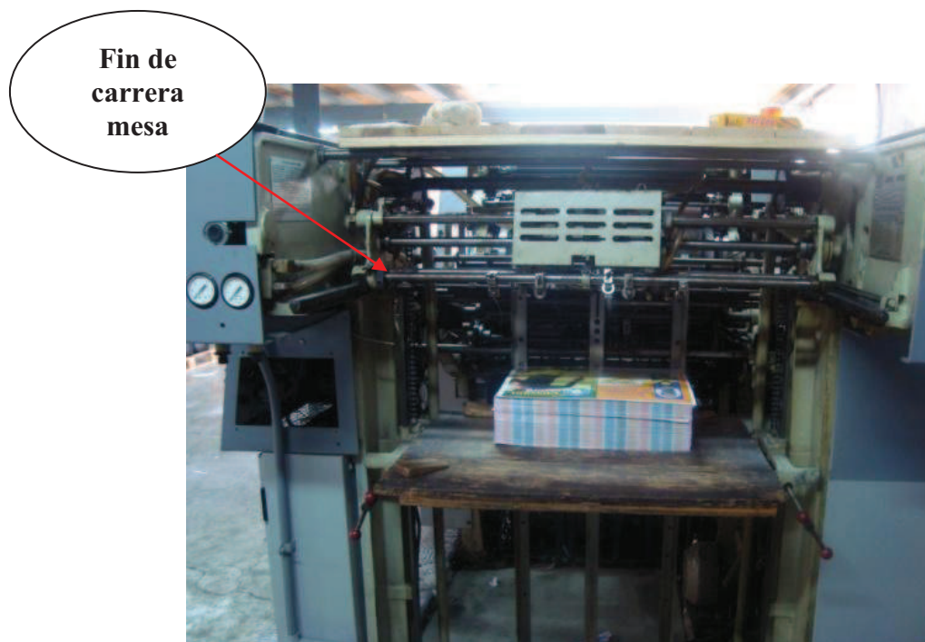
Figura 2.10 Fin de carrera en la mesa ingreso de papel, Imprenta Don Bosco.
