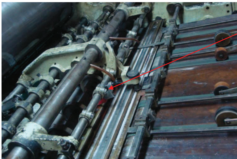
Figura 2.4 Detector de papel previo a la repotenciación, Imprenta Don Bosco.
