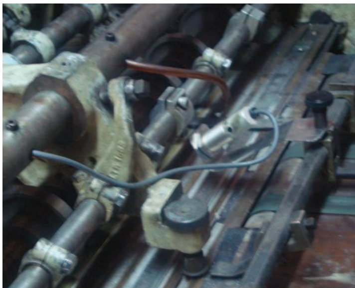
Figura 3.6 Sensor infrarrojo para detectar presencia de papel.
