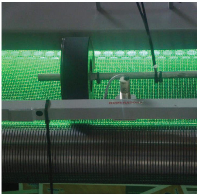
Figura 3.7 Sensor infrarrojo para contar producto final.
