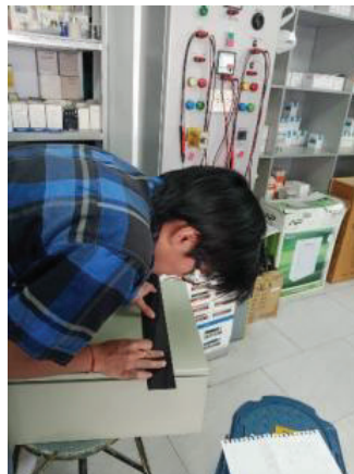
Figura 2.12 Trazo de cuadrícula en Gabinete Eléctrico.
