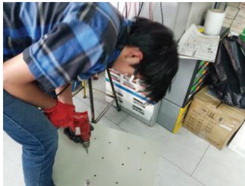
Figura 2.17 Perforación de panel delantero.
