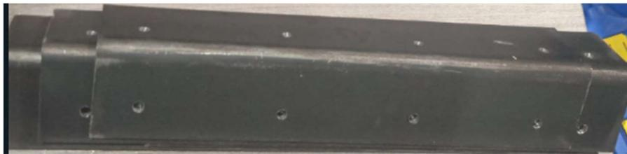
**Figura 2.12** Perfiles utilizados para soportes y uniones tipo perfil
