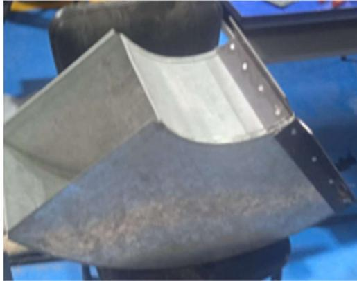
**Figura 2.16** Preparación del codo con perfiles para su unión
