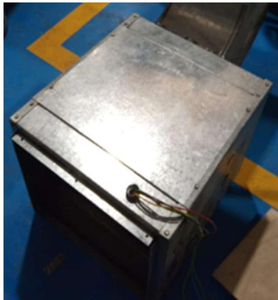
**Figura 2.2** Extractor proporcionado con su carcasa
