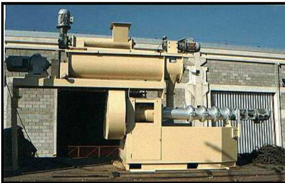
**Fotografía 1.2: Extrusor completo de tornillo simple con alimentador, acondicionador y cortadora.**
