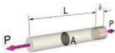
**Figura 1.5.** Alargamiento axial y contracción lateral de una barra sometida a tracción.<sup>3</sup>
