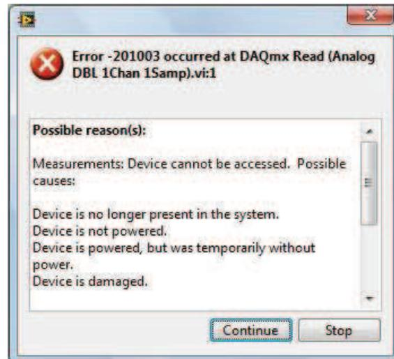
**Figura 4.5.** Pantalla “Falla de comunicación PC – DAQ”.
