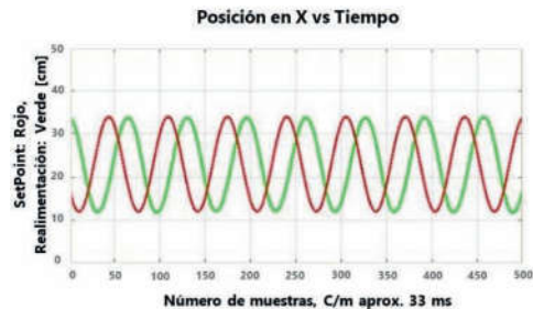
Fig. 13. Círculo: Seguimiento en el plano XY – Rojo: Referencia, Verde: Posición medida
