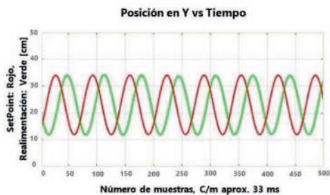
Fig. 14. Círculo: Seguimiento de la señal de referencia – Rojo: Referencia, Verde: Posición medida
