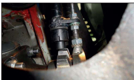
Fig. 18 Sensor de velocidad implementado.
