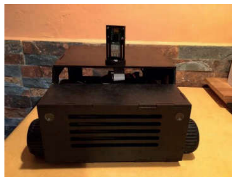
Fig. 11. Prototipo de robot móvil que aprende a detectar diferentes señales de tránsito mediante inteligencia artificial.
