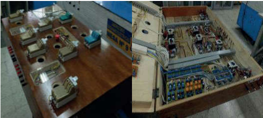
Fig.10. Hardware utilizado para emular un sistema SCADA de laboratorio.
