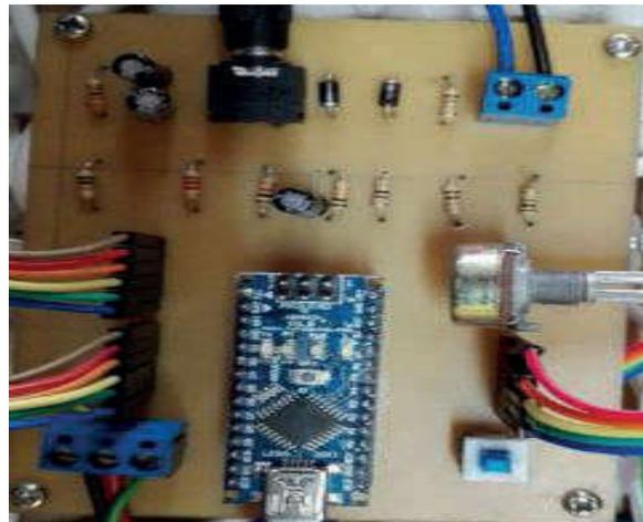
Fig.4. Placa del sistema de adquisición de datos[2].
