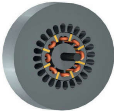
Fig. 3 Estructura T/R HESM de Ocho Polos
