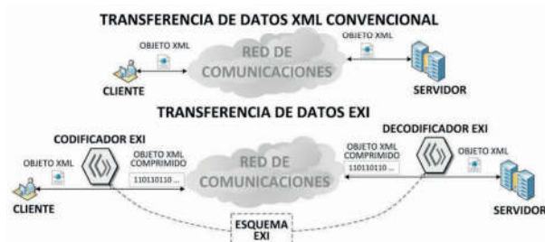
Figura 7. Comparativa entre transferencia de datos convencional y transferencia de datos basada en esquemas EXI.
