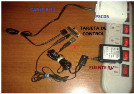
Fig. 4. Conexiones para el convertidor X-10 a IR
