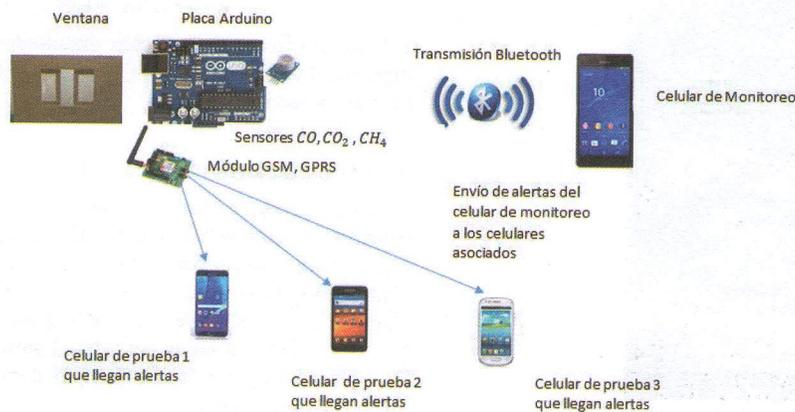
Fig. 4. Esquema general del prototipo de monitoreo
